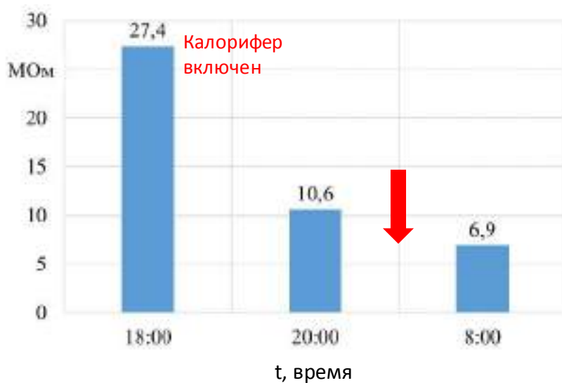
Рисунок 2 – Результаты предварительного эксперимента: а – сушка ОВ ТЭД 7-8 при помощи ЭОС без подключенного калорифера; б – сушка ОВ ТЭД 5-6 только калорифером
