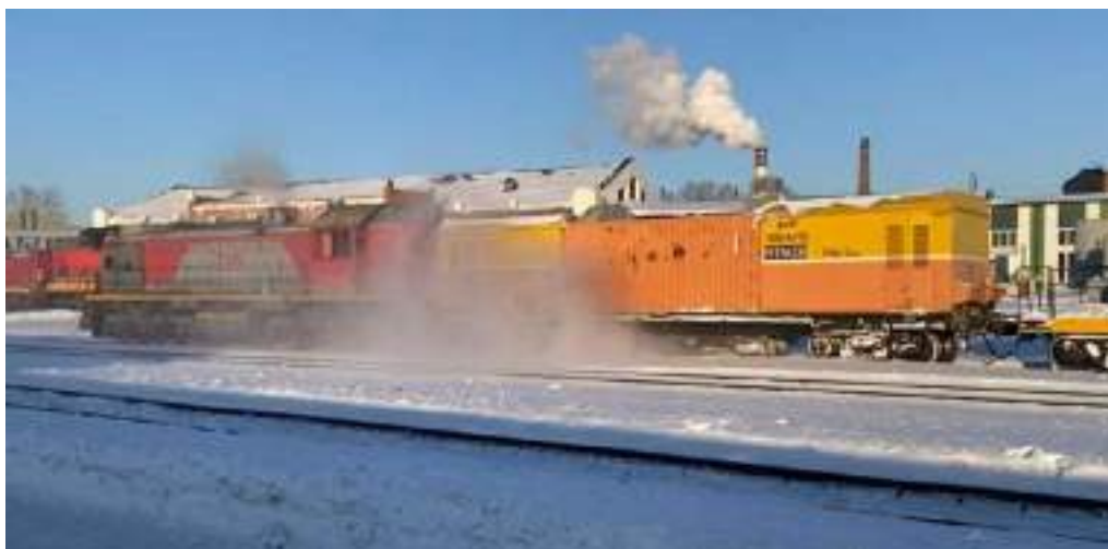
Рисунок 5 – Испытания рабочего поезда ПОМ1-М с одним маневровым локомотивов серии ТЭМ2
