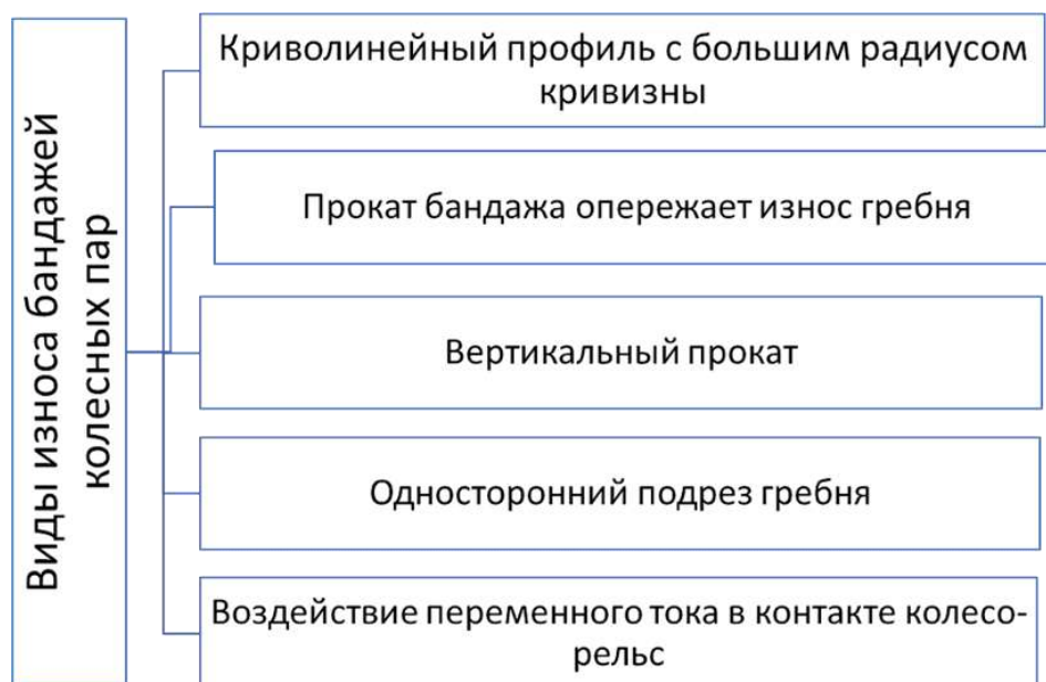
Рисунок 2 – Основные виды износа бандажей колесных пар подвижного состава
