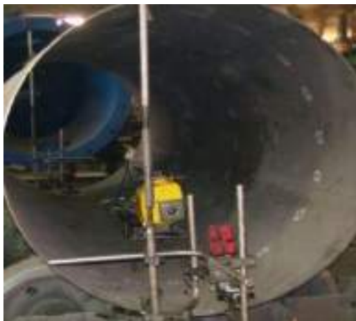
Рисунок 2 – Оптико-электронный прибор контроля геометрических параметров крупногабаритных корпусных изделий
