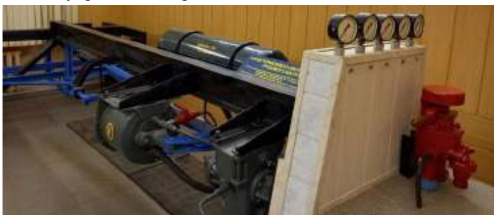
Рисунок 7 – «Стенд тормозного оборудования грузового вагона»
