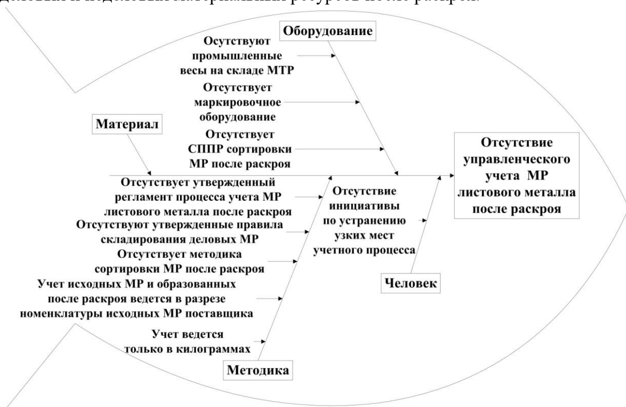
Рисунок 1 – Причинно-следственная связь отсутствия управленческого учета материальных ресурсов, полученных после раскроя
