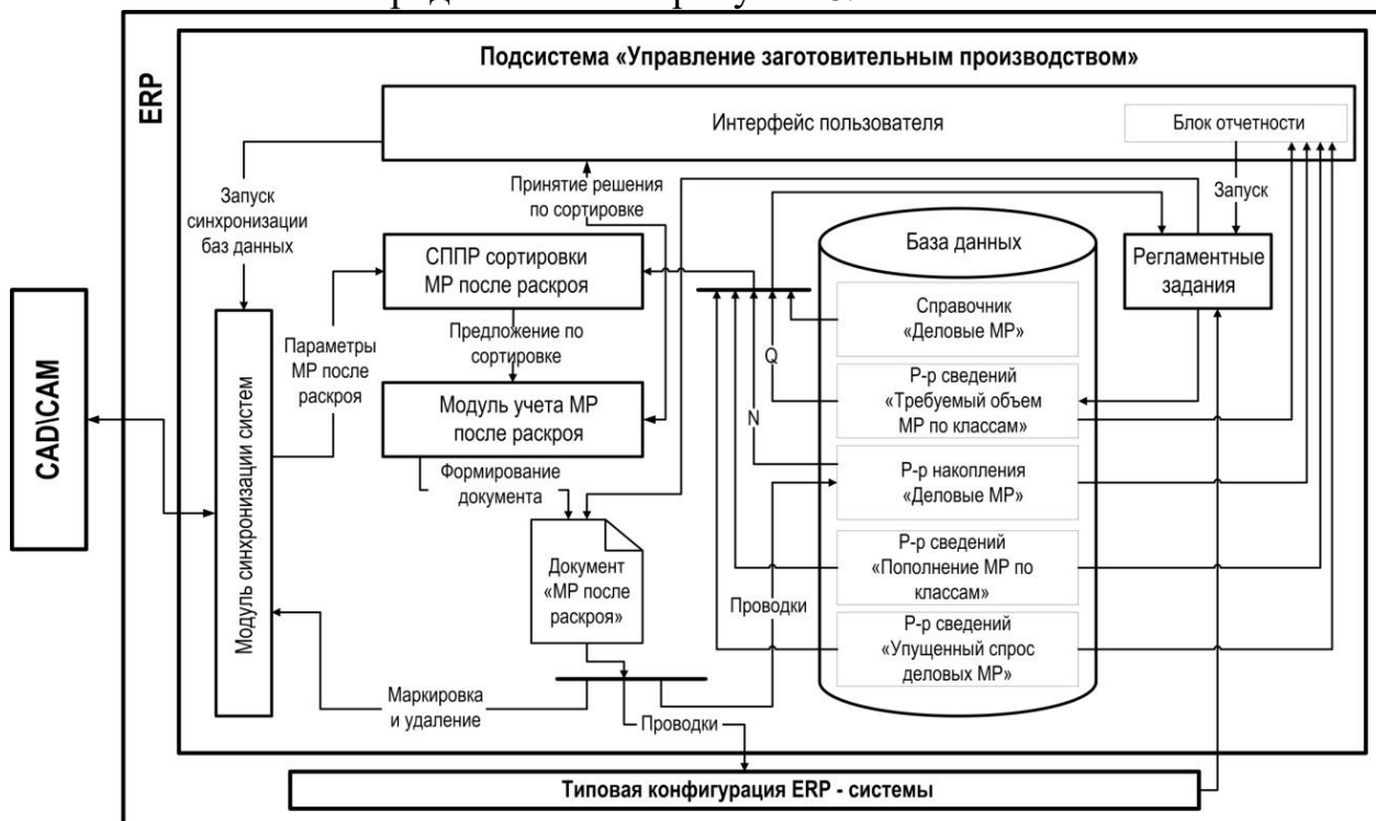
Рисунок 6 – Структура подсистемы «Управление заготовительным производством» в рамках ERP-системы
