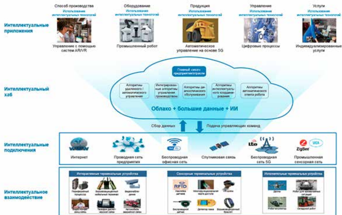
Рис. 3. Процесс цифровой трансформации промышленного предприятия [4]
