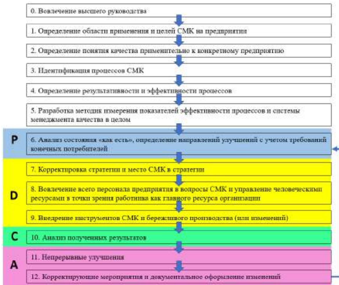
Рисунок 6 – Алгоритм создания и функционирования системы менеджмента качества предприятий
