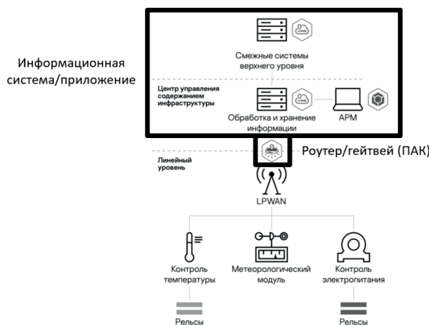
Рис. 3. Схема умного обогрева железнодорожных стрелочных переводов
